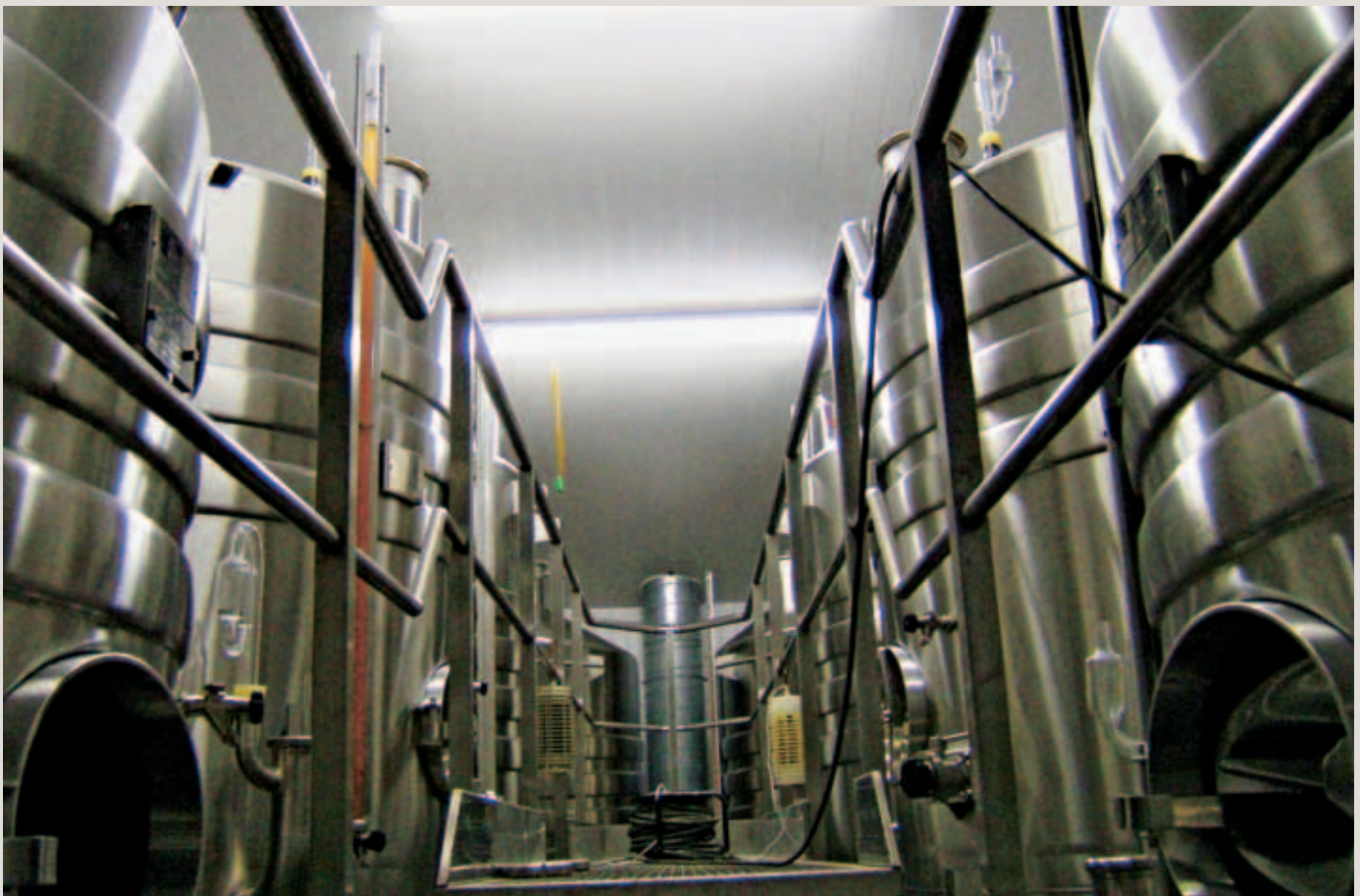
Champagner-Grundwein wird genauso wie anderer Wein hergestellt, mehrheitlich in Temperatur-kontrollierten Edelstahltanks. Gesehen bei Champagne Faÿ Michel in Barzy-sur-Marne.
